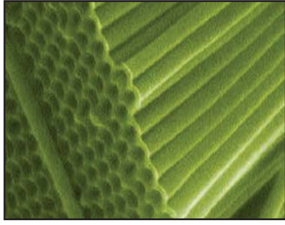
● رسم تقريبي لكيفية صف أنابيب الكربون النانوية لتكوين أغشية التنقية.
